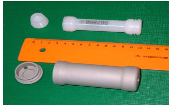
Abb.2: Bestrahlungskapseln der RPA (oben) und der KBA (unten)
